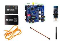
B91 通用开发套件是 Telink 最新一代 TLSR9 系列芯片的通用 开发平台。该套件的核心是一块 B91 开发板,其上搭载了一颗 TLSR9 系列的旗舰型号芯片。结合赠送的烧录和调试工具及相关配件,B91 通用开发套件可用于实现各类物联网应用的原型开发。针 对大学生物联网竞赛,推荐选择 TLSR9218 作为目标芯片进行开发。
