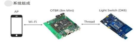
全兼容:支持 Zigbee3.0、BLE5.0, WiFi, Thread, Matter, Ethernet; 可扩展:提供 Matter 基于 Router 设备的开发包,支持主平台的二次开发; 易用性: MCU 下载器支持 Jilnk & CMSIS-DAP,支持标准 SWD/JTAG 接口,方便易用,工程师必备神器参考资料:
